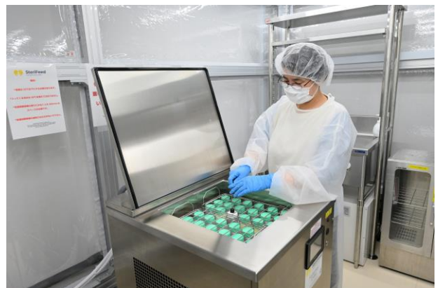
▲最新式低温殺菌処理器からドナーミルクを取り出す様子
